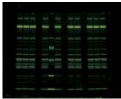
タンパク質の PAG 電気泳動直後の蛍光 (UV 又は BlueLED) 検出
